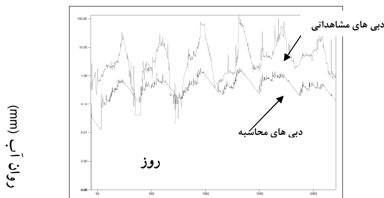
شکل (۷): مقایسه رواناب مشاهداتی با مقادیر برآورد شده از مدل در دوره واسنجی برای مدل AWBM
